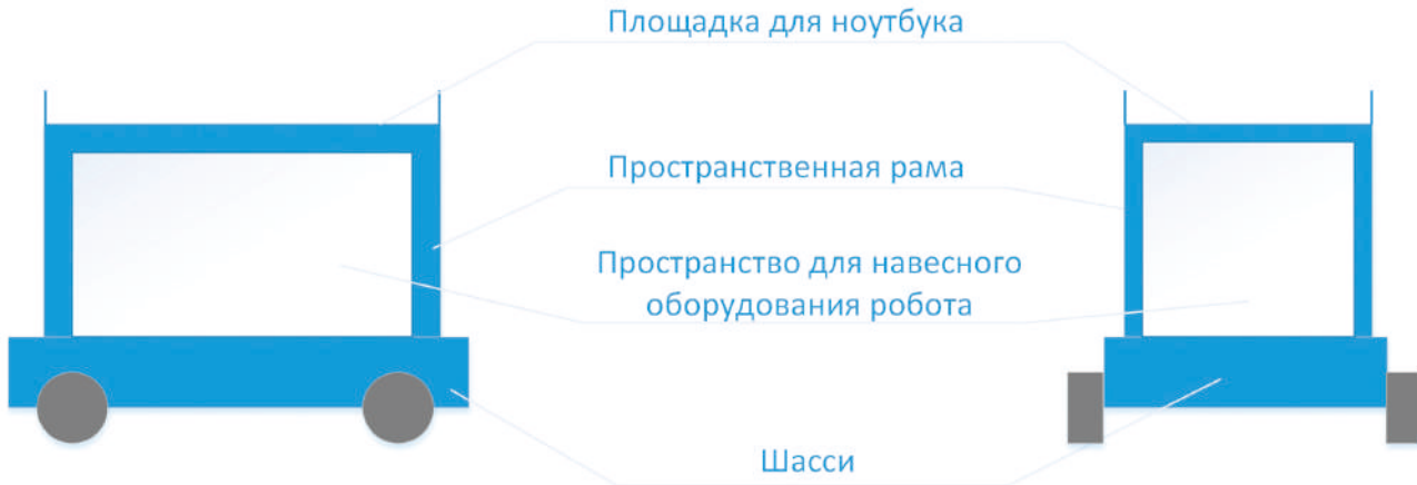
Рис. 3.6. Схема пространственной рамы робота с платформой для ноутбука
